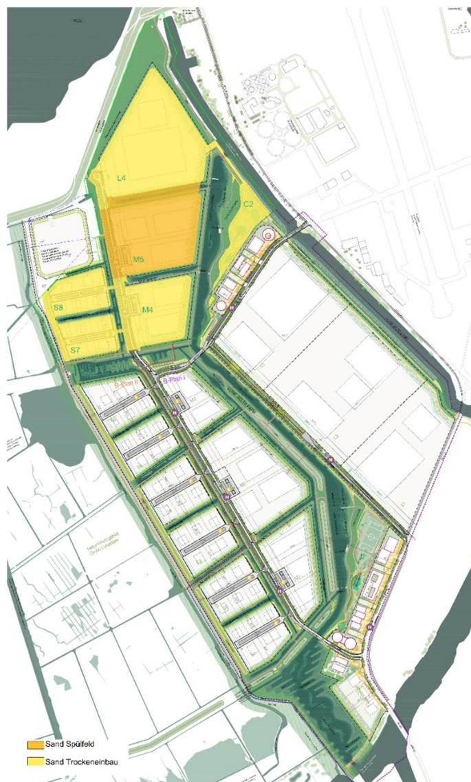
**Abbildung 7 - Warften und Einbaukonzept (Nass- und Trockeneinbau) für B-Plan III**
